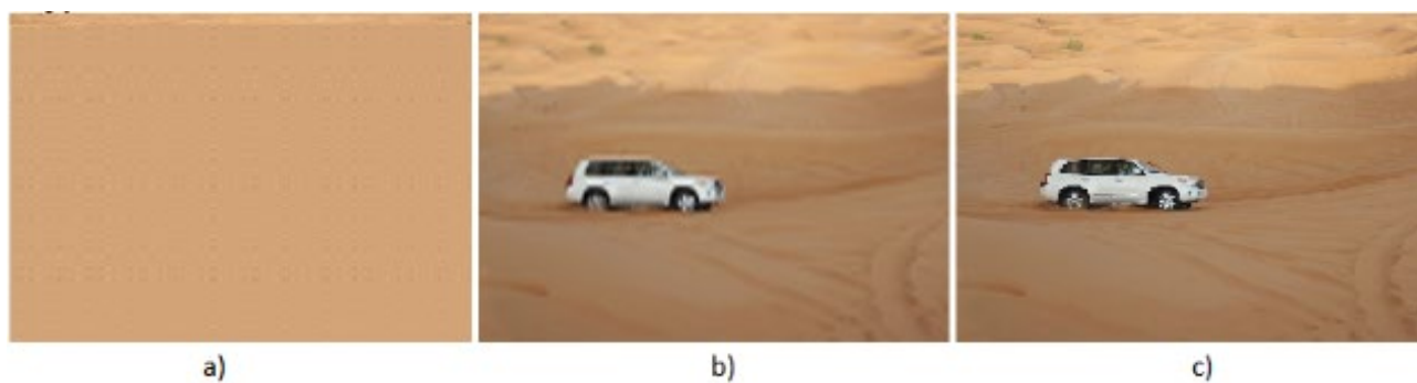
Рис. 2. Результат частичной загрузки изображения в разных форматах: a) – Baseline JPEG; b) – Progressive JPEG; c) – Progressive JPEG 2000
